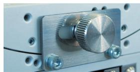
ゴシックアーク、Zステージ、スイベルステージに使用されています。板バネをクランプネジで移動体に押しつけて、移動体をクランプします。
