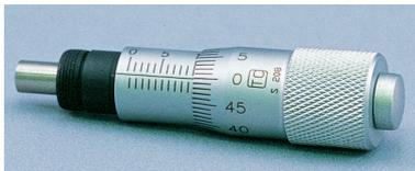
マイクロメータヘッドは、精密に位置を決めるための器具で、研削加工されたネジと雌ネジで構成されています。スリーブの目盛とシンプルなバーニア目盛を組み合わせることで、10 $\mu$ m単位までの位置読みとりが可能です。
