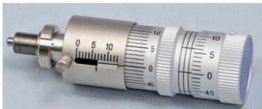
精密ポジショナーは、精密位置決め用に開発されたアクチュエータです。送り方式は研削ネジを利用した粗動と、弾性ヒンジを利用した微動から成り立ちます。弾性ヒンジ構造の採用でネジの噛み合わせによるバックラッシュを無くし、50nm程度の感度で位置決め調整ができます(詳細はO-008ページ)。
