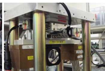
天吊り(逆さ)設置
