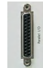
コントローラに平行インターフェース装着時 Parallel interface connector
