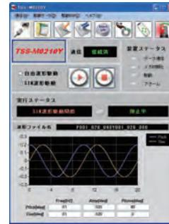
駆動制御ソフトウェアを使用することにより、自由波形・sin波・合成sin波・振幅変調波・周波数変調波等の駆動データをコントローラへ簡単に転送し、駆動させることが可能です。自由波形の駆動は解析に余裕のある64秒まで設定可能です。また、任意のトリガ出力も可能です。
