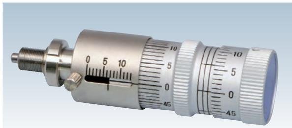
FPP03-13は高分解能を要求する光デバイス組立用調芯装置のために開発された駆動機構です。±0.1dBの調芯操作にもスムーズに追従します。独自の内部構造により、従来のマイクロメータでは困難だったサブミクロンの位置決めが可能となりました。また、ノンバックラッシュを実現しました(弊社ステージ取付時)。
