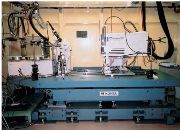
この装置は、蛋白質などの生体高分子の構造解析に特化した装置です。試料の回転ステージは、 $10\mu\text{m}$ 程度の結晶を測定するため回転中心変位量が $1\mu\text{m}$ 以下に抑えられています。また、高強度のX線を受けると試料の揺動が問題になるため、msec単位でON/OFF制御のできるシャッターを装備しています。X線CCDカメラは、試料から40mmまでの距離まで近づけることができ、解析に必要な回折線を十分にカバーできるようになっています。この装置は、日本の放射光施設KEK PF (Photon Factory) に5台納品しました。
