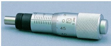
マイクロメータヘッドは、精密に位置を決めるための器具で、研削加工されたネジと雌ネジで構成されています。スリーブの目盛とシンプルなバーニア目盛を組み合わせることで、10 $\mu$ m単位までの位置読みとりが可能です。
