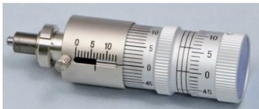
精密ポジショナーは、精密位置決め用に開発されたアクチュエータです。送り方式は研削ネジを利用した粗動と、弾性ヒンジを利用した微動から成り立ちます。弾性ヒンジ構造の採用でネジの噛み合わせによるバックラッシュを無くし、50nm程度の感度で位置決め調整ができます(詳細はO-008ページ)。
