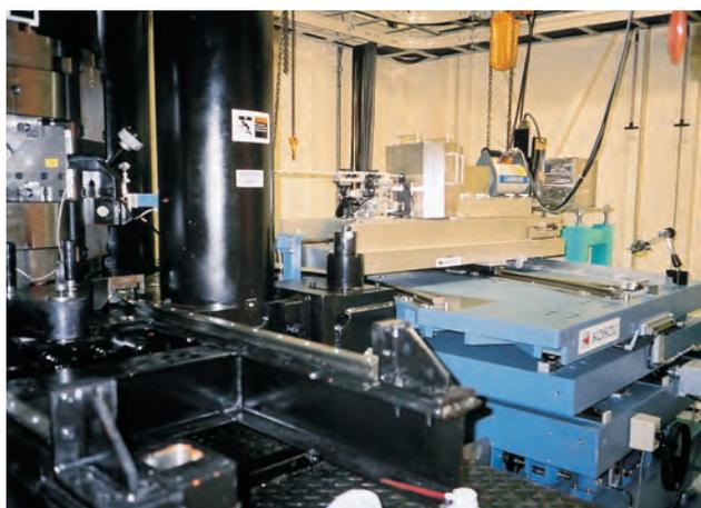
左の装置は、高圧状態に置かれた試料からの回折線をエネルギー分散法で計測するための架台と位置決め調整用の装置です。回折線を $\theta$ - $2\theta$ の関係を保ちながらエネルギー分散法で測定することができます。検出器は、試料を中心としたステージに置かれ、その回転中心変位量は $50\mu\text{m}$ 以下です。この装置は、日本の放射光施設SPring-8 (Super Photon ring-8 GeV) BL04B2に納品されました。
