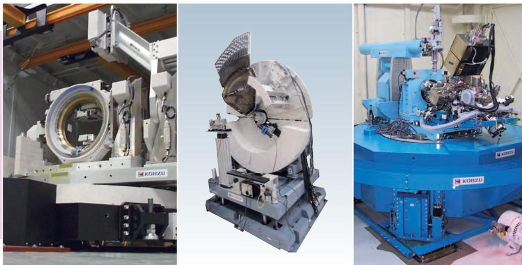
X線回折計は、単色のX線を試料にあて、その回折強度を測定することで、試料の結晶構造を決定する装置です。神津精機は、1990年にオーダーメイドで製造した $\kappa$ (カッパー)ゴニオメータ方式の回折計にはじまり、日本のSPring-8、ドイツのDESY Petra-III、イギリスのダイヤモンドなどの放射光施設や米国のNASAなどの海外の研究所に、多くのオーダーメイドの回折計を提供してきました。これらの多くの経験は、多軸型単結晶回折計NZDシリーズや、多連装粉末回折計PDSシリーズなどに実を結んでいます。
